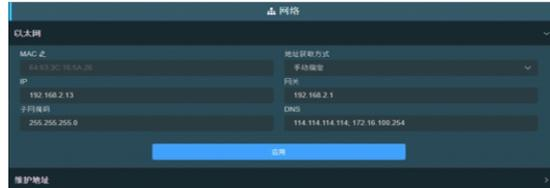
**注：**当设备设置为DHCP动态获取地址后，下次使用设备时，正确连接后，NDI软件可自动发现设备，无需登录管理页面即可直接使用。
