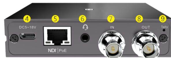
4 TYPE-C电源接口 5 1000M以太网口(支持POE) 6 音频接口
