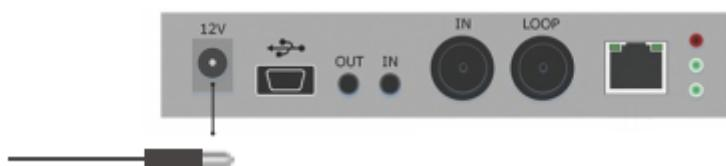
**⚠ 注意：**请尽量使用设备标配电源适配器给设备供电，使用其他不合格电源供电可能会损坏设备。
