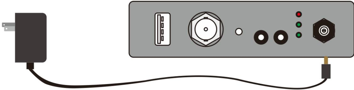
**⚠ 注意：请尽量使用设备标配电源适配器给设备供电，使用其他不合格电源供电可能会损坏设备。**
