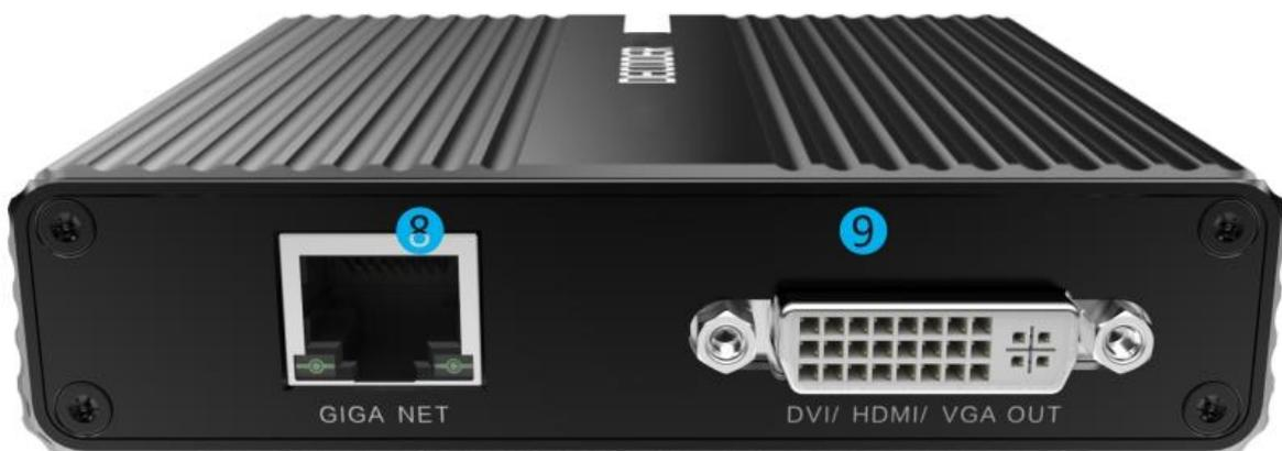
8. 100/1000M Ethernet port    9. DVI/HDMI/VGA output
