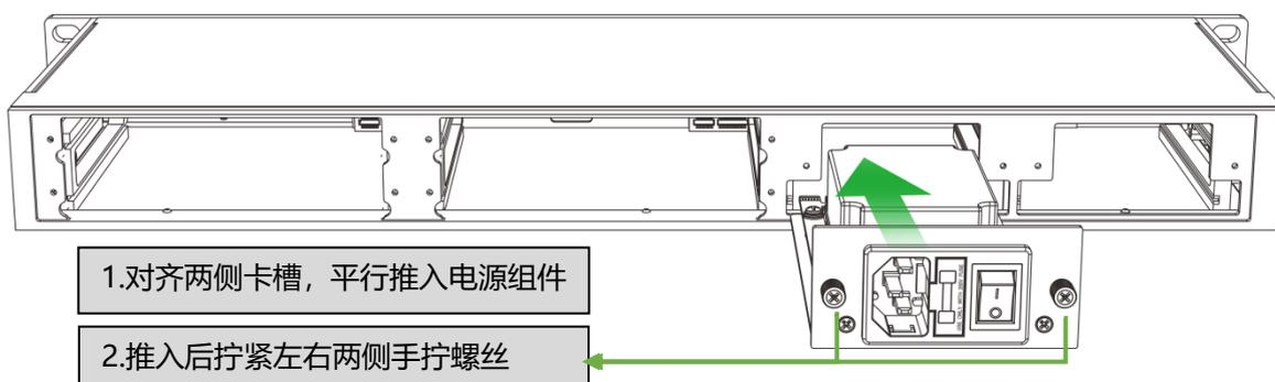
注：两个电源组件同时不间断工作，当其中一个组件断电或者损坏时，设备不会断电。更换电源组件可以在设备不断电情况下进行。
