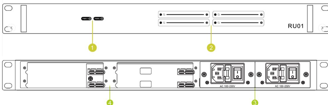
1.电源指示灯    2.卡板工作指示灯    3.电源卡槽    4.卡板卡槽
