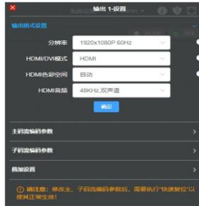
设置解码输出格式和编码参数。“叠加设置”即对整个窗口输出画面的Logo和背景图片进行设置（需提前在“图片管理”菜单添加所需图片，Logo图片建议小尺寸，否则会覆盖大部分的画面。），设置后对SDI/DVI接口输出画面和输出流画面均产生作用。
