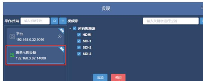
添加之后在视频源列表看到其显示为REMOTE，有视频正常输入的接口会显示视频画面，5s更新一次，无视频输入的接口显示为蓝屏。（此时正常显示的视频源的码率会显示为0Kbps，只有当选择其进行解码输出的时候，才会显示实时码率）
